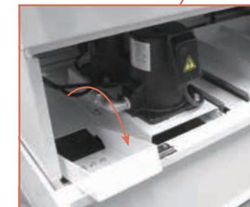
维修盖打开，取出导油管的状态
